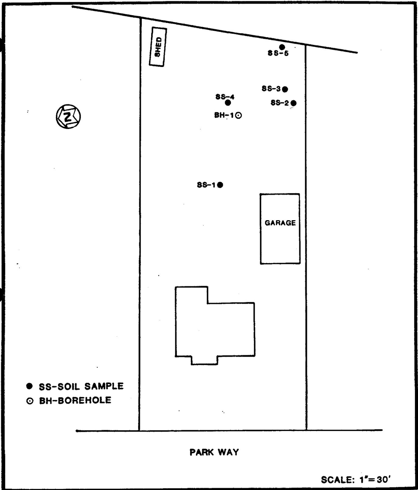
FIGURE 4-2B LOCATIONS OF SURFACE SOIL SAMPLES AND BOREHOLE AT 86 PARK WAY
